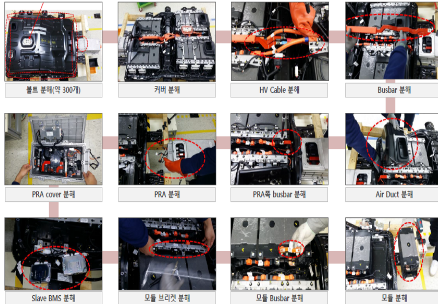
[그림 3] 전기차 사용후 배터리 재목적화 공정을 위한 분해공정
