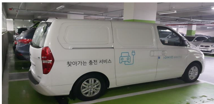
[그림 5] 이차사용 배터리 팩을 활용한 이동식 충전지원 차량 전경
