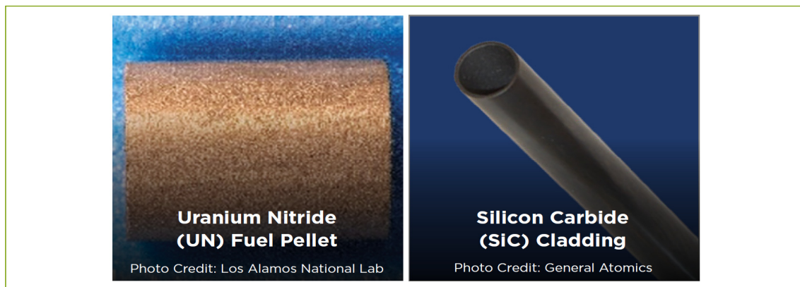
그림 10 WEC사의 장기 적용 ATF UN 소결체 및 SiC 피복관
