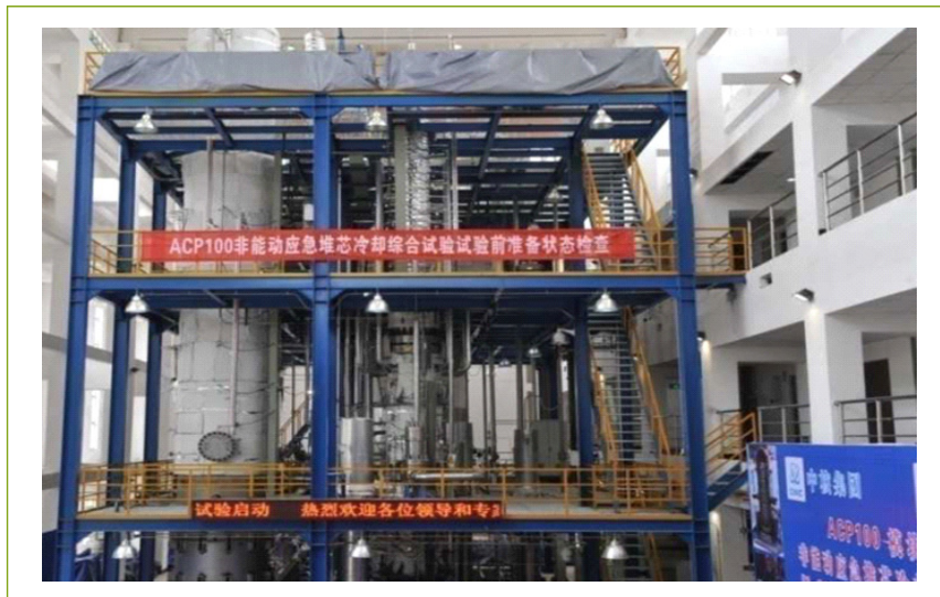
그림 1 ACP100 노심냉각시스템 통합시험 및 피동형 잔열제거시스템 시험 수행을 위해 CNNC가 건설한 시설
