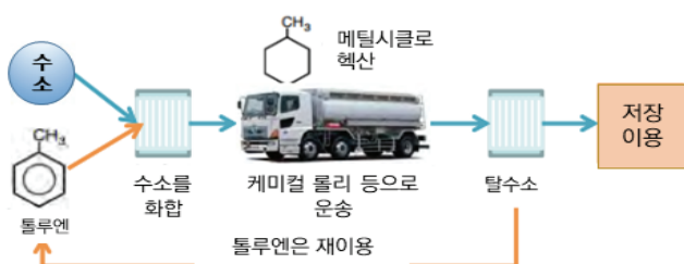
[그림 2-11] 수소의 메틸시클로헥산(MCH) 형태로의 운송·저장
